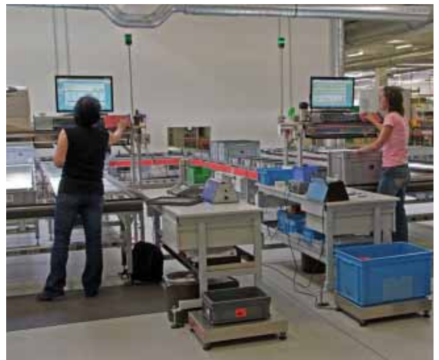
Kommissionierplätze des automatischen Kleinteilelagers
